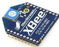
Fig. (5): Xbee module
