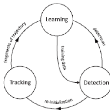
شکل (۱): ساختار الگوریتم سنتی ردیابی یادگیری تشخیص
