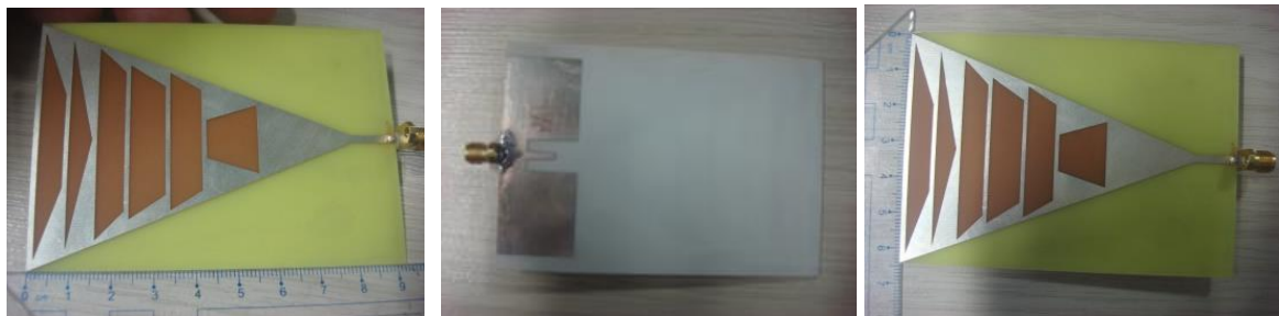
شکل (۱۰): آنتن ساخته شده فرکتال ذوزنقه بالای های مکمل همراه با شش تکرار Figure (10): Fractal trapezoidal antenna made of complementary top with six reps
