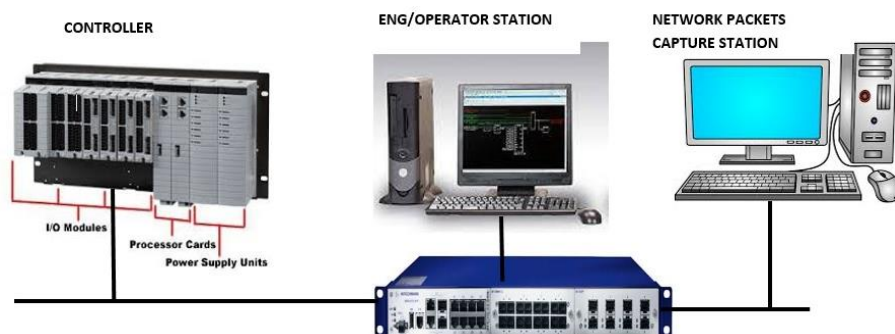
شکل (۶): مجموعه تست سیستم کنترل یوگواوا
