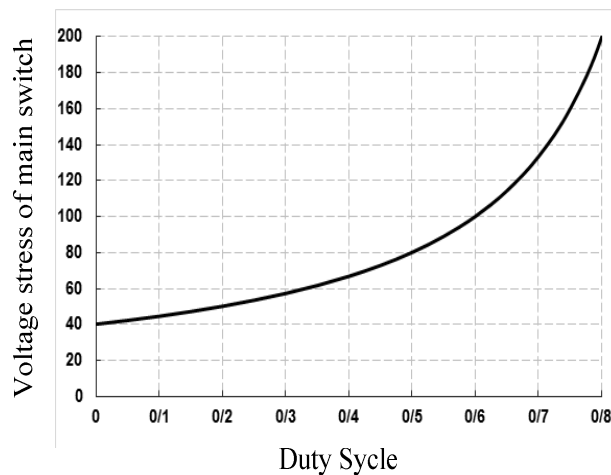
شکل (۱۰): نمودار تغییرات استرس ولتاژ سوئیچ اصلی بر حسب تغییرات ضریب وظیفه Fig. (10): The voltage stress across the main switch against different duty cycles
